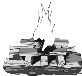
AFB. 4.7 Brandende aansteekmodule op de stapel met brandhout
