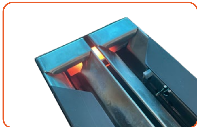
Figure. 4.5 PRIMING: Brandstof wordt ontstoken
