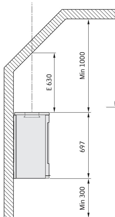
Der skal være mindst 1,1 meter foran brændeovnens åbning til brændbare bygningsdele eller indbo.
