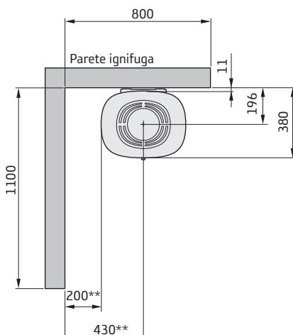
\*\* Per evitare deterioramenti delle pareti ignifughe dipinte, si consiglia di mantenere la stessa distanza indicata per le pareti infiammabili.
